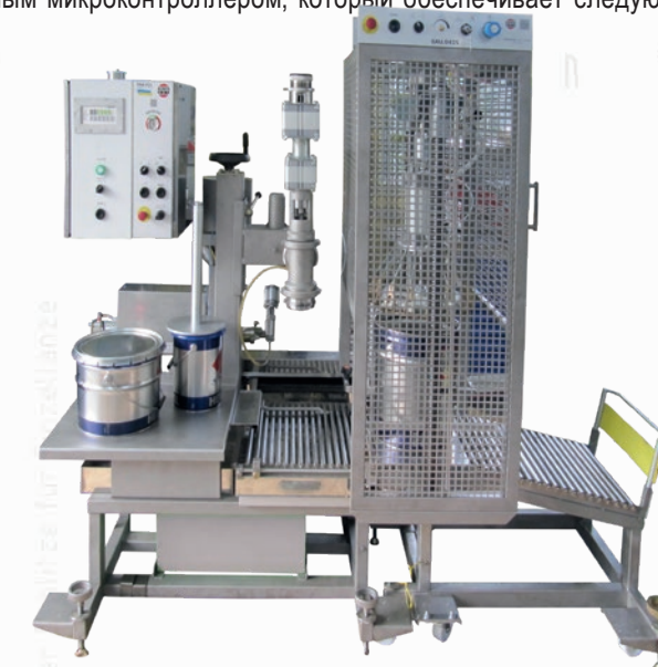
PRK.024 with capping unit for lug lid ПРК.024 с устройством укупоривания крышек "корона"
